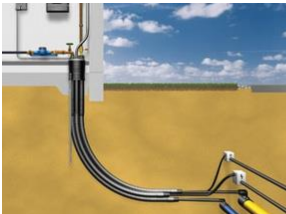
Abbildung 1: Bodendurchführung für nicht unterkellerte Gebäude
